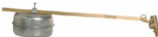
El piloto P-10 es un piloto de flotador de 2 vías al que se le ajusta un brazo móvil. Cuando el agua alcanza el máximo nivel, el flotador se levanta, cerrando el paso de agua del piloto, ordenando el cierre a la válvula principal.
